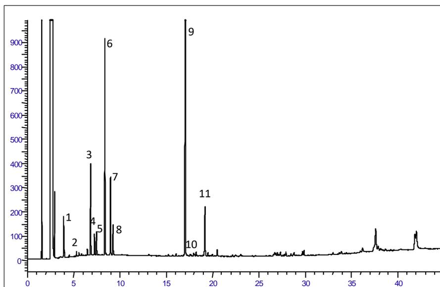
**Figura 1** – Cromatograma ilustrativo obtido com o óleo volátil de *Melaleuca alternifolia* (Maiden & Betche) Cheel por cromatografia à gás acoplada a detector por ionização de chama. 1-  $\alpha$ -pineno, 2- sabineno 3-  $\alpha$ -terpineno, 4- limoneno, 5- 1,8-cineol, 6-  $\gamma$ -terpineno, 7- *p*-cimeno, 8- terpinoleno, 9- terpinen-4-ol, 10- aromadendreno e 11-  $\alpha$ -terpineol.
